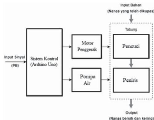
Gambar 2. Diagram blok mesin pencuci dan peniris nanas.
