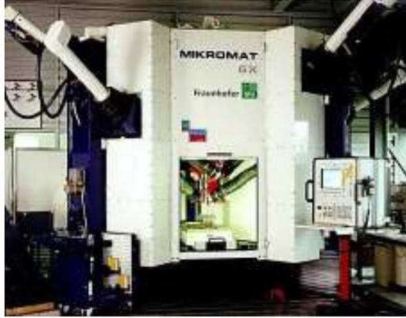
Gambar 3-5 Mesin Freis 5 Sumbu Mikromat Hexa 6X
