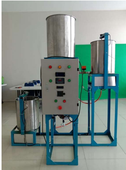
Gambar 5 Mesin pemanas dan pengaduk minyak jelantah pada proses esterifikasi
